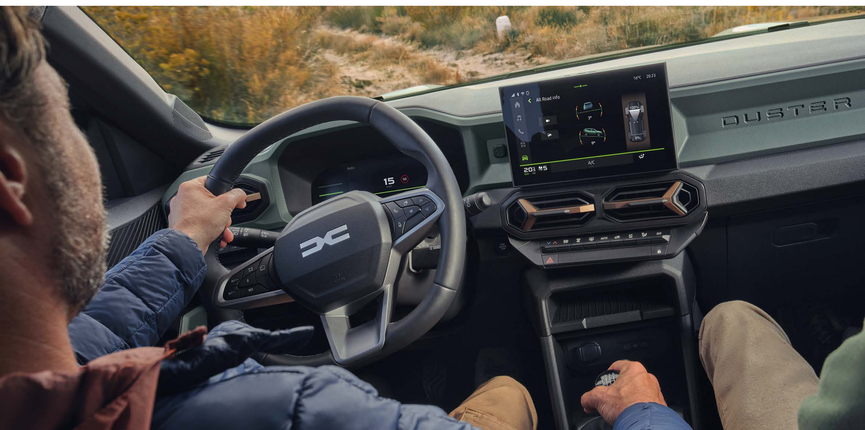
Ecrã tátil com informações 4x4 : ângulos de inclinação e potência por eixo
